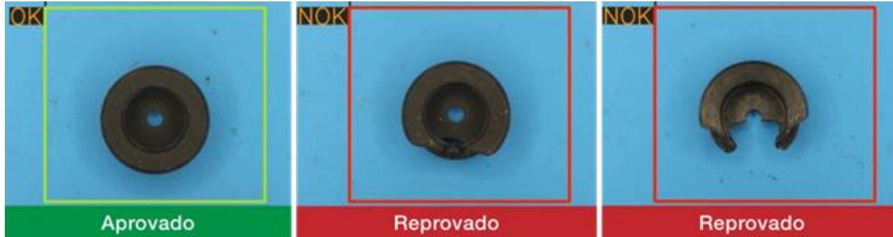
**WEG Digital Solutions (Brasil)** – Produce piezas de caucho para el sector automotriz (ej. manguitos, sellos). Emplea visión por computadora basada en IA (redes neuronales convolucionales) para inspeccionar automáticamente las piezas y detectar defectos físicos (rasgaduras, agujeros, manchas) [weg.net](http://weg.net).
